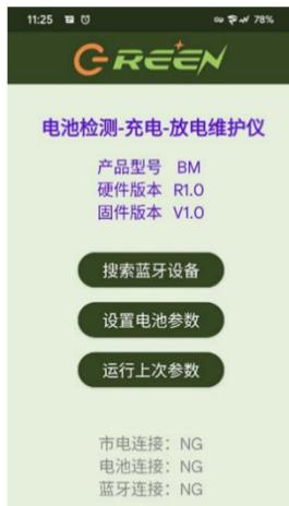
**注意：若电池未连接，会提示“请接入电池!!!”，此时【设置电池参数】和【运行上次参数】两个按键会被隐藏。**
