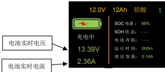
电池充满后，根据充电开始时电池所带电量的不同，显示屏会有两种不同的显示内容：
