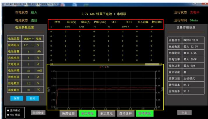
点击之后，对应功能模块背景色会绿色亮起，BM200从机设备开始充电。与此同时，红色方框内开始实时显示电池数据，黄色方框内开始记录充电曲线。
