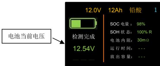
SOC电量百分数是依据当前电压与设备学习构建的SOC电压对照表查表计算得到。没有经过完整充放电学习的情况下，快速检测得到的SOC误差可能会比较大，仅供参考。
