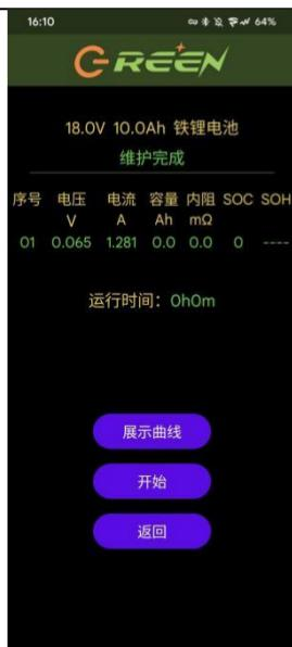
当充电或放电结束后可点击【展示曲线】按键，进入充放电曲线查看界面，若在充放电过程中点击【展示曲线】按键则会提示“非完整充/放电过程，无法测定充/放电曲线”。
