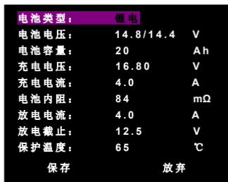
此时按下《Down》键2次，电池类型右侧“锂电”变为“铅酸”，与之相对应的电压等参数也会相应变化，具体显示如下图。
